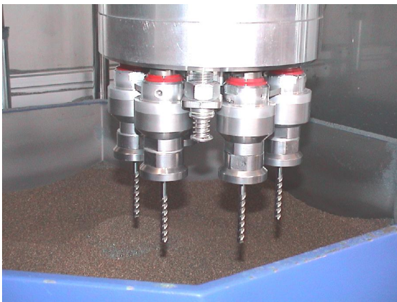
Bild : bestückter Werkzeughalter kurz vor dem Eintauchen in den Arbeitsbehälter.
